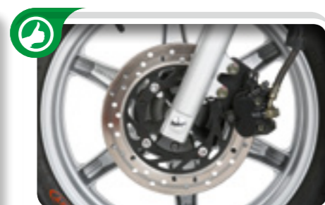
"Para frenar equipa un disco delantero y otro trasero, con pinzas de dos pistones paralelos".
